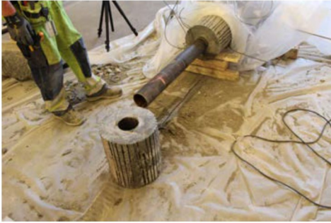
Bentonitsegment taget från det första paketet som togs upp.
