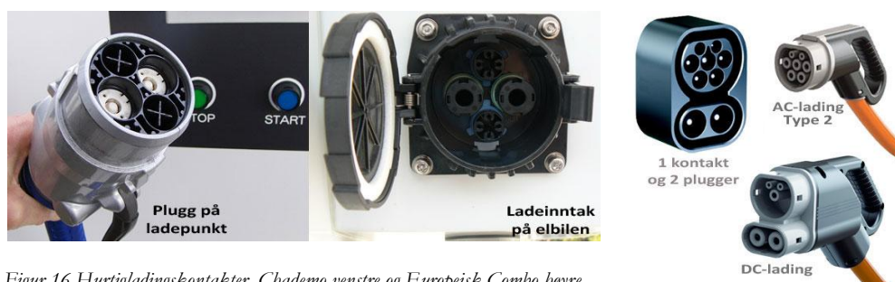
Figur 16 Hurtigladingskontakter, Chademo venstre og Europeisk Combo høyre Kilde bilder: www.ladestasjoner.no
