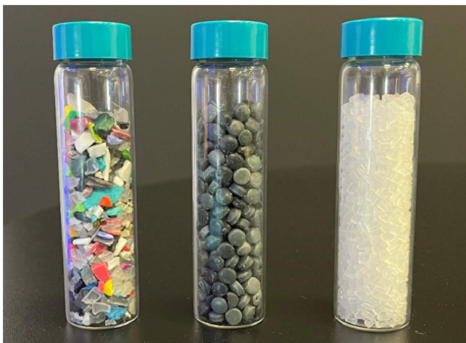
Figur 3. Ingående blandning av PP och PE (till vänster) utgående ren PP (till höger)
