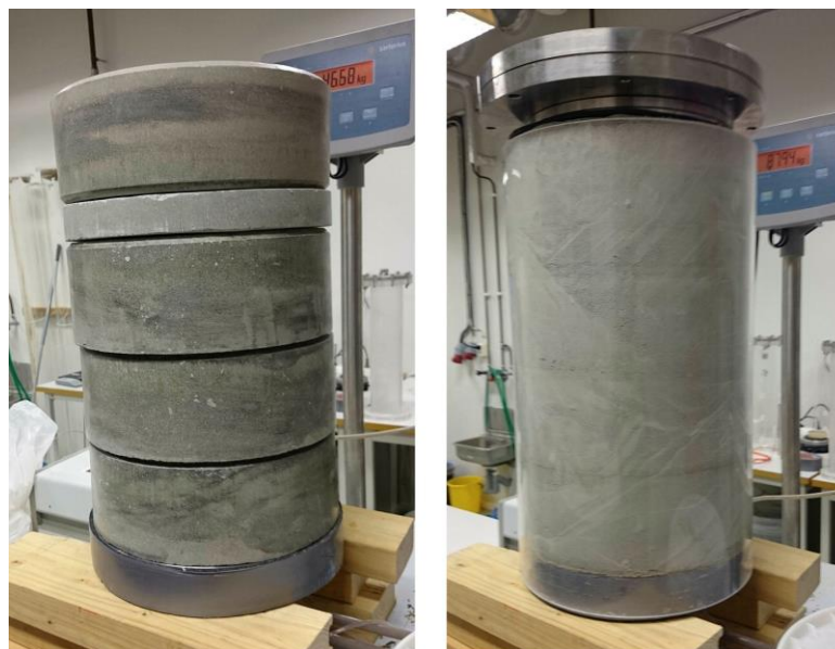
Figur 3-2. Fotografier från försöksuppställningen där en kopparvärmare innesluts av fyra bentonitringar och sedan täcks av ett massivt bentonitblock.
