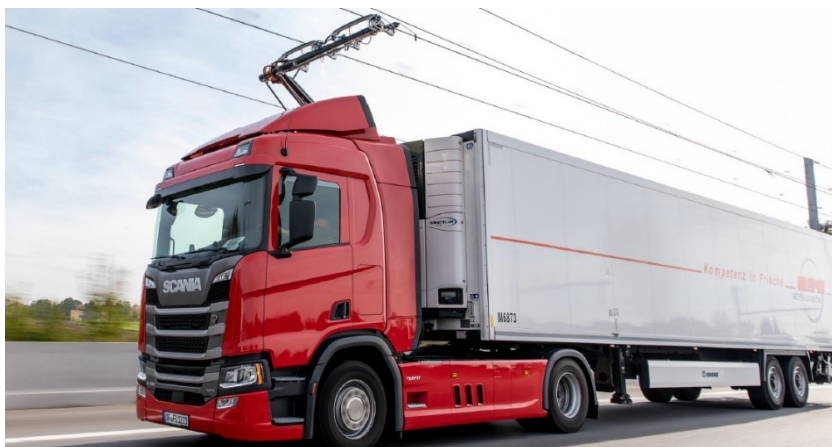
Figur 3.6 Siemens luftledningar med lastbil
