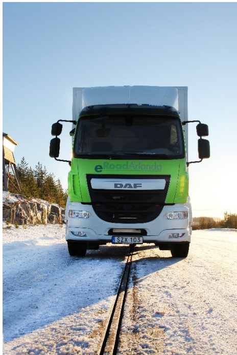
Figur 3.8 Elways nedsänkta skena med lastbil
