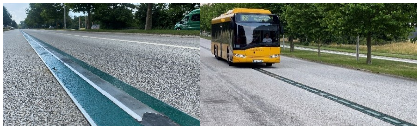
Figur 3.9 Elonroads upphöjda respektive nedsänkta skena
